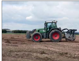
Im Teilgebiet Schürhübel wurden Fichtenschlagflächen vor der Mähgutauftragung mit einem Forstmulcher bearbeitet.
