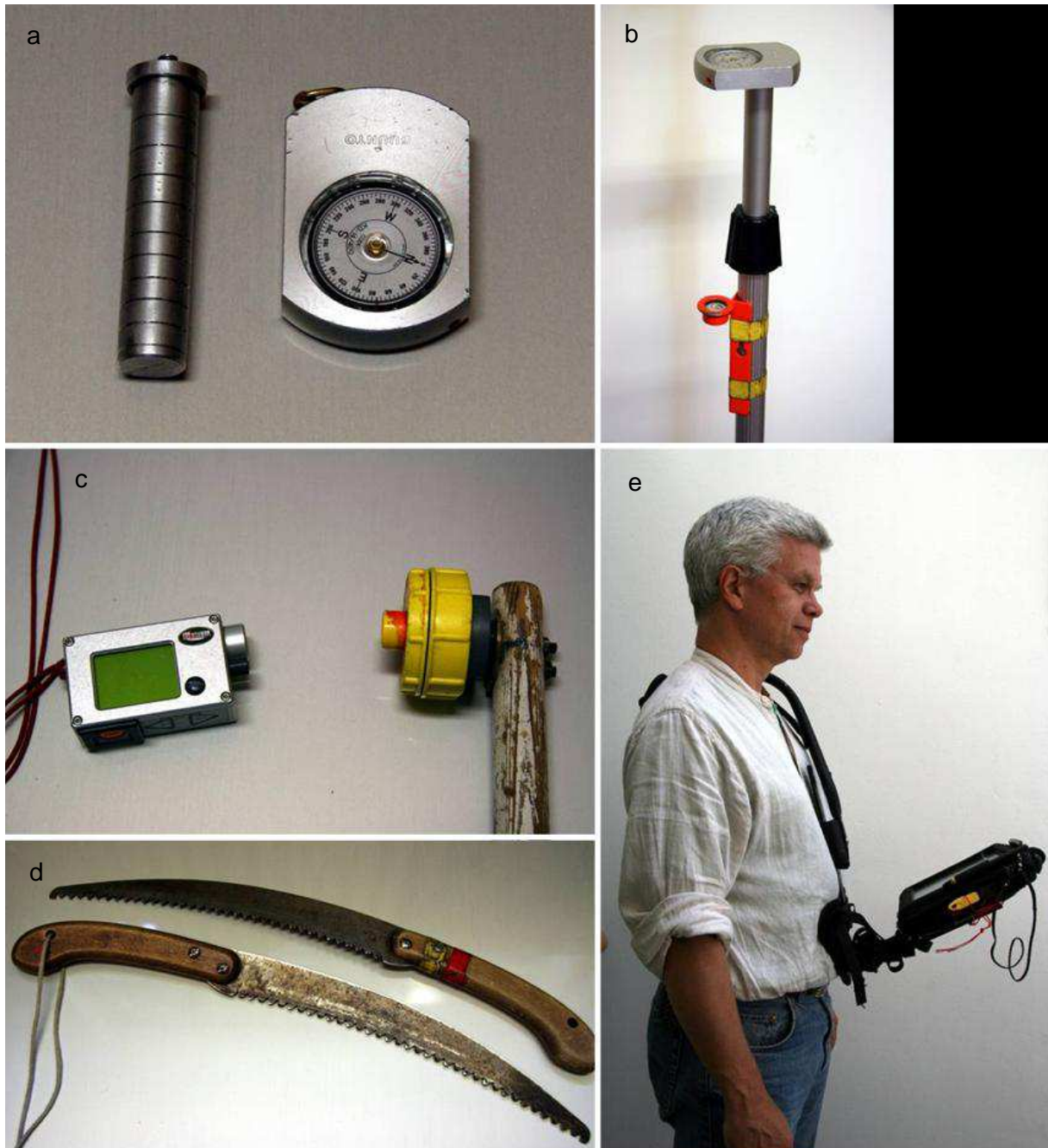
Abb. 9: Messinstrumente und Ausrüstung: (a) Suunto-Busssole mit Steckkerze, (b) Einbeinstativ mit Busssole und Lattenrichter, (c) Vertex IV © mit Transponder T3,, (d) Zugsäge zur Markierung der BHD-Messstelle,(e) Tragevorrichtung für den DRS Hammerhead.
