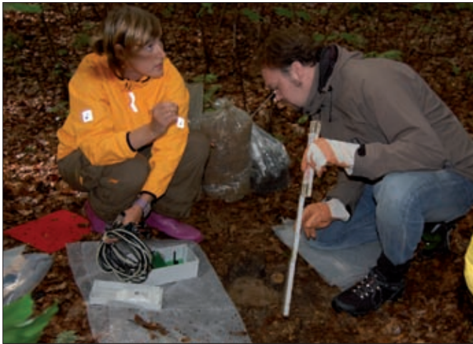
Einbau der Bodensensoren am Forschungsstandort Wüstebach.
