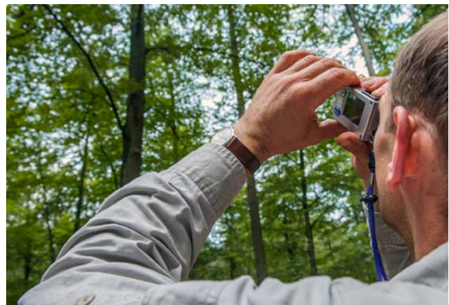
An einigen Bäumen wird die Höhe wie hier mit einem Ultraschall-Messgerät gemessen, um die Baumform und damit das Baumvolumen genau bestimmen zu können.
