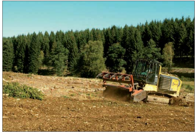
Mulchen der Fichtenschlagfläche
