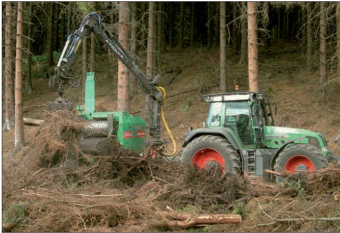
Hacken und Verblasen von Fichten-Astmateriale
